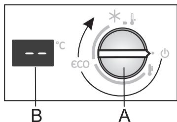
**Pour mettre l'appareil en marche,** tournez le bouton **A** dans le sens des aiguilles d'une montre.
