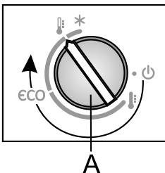
Si la température de la pièce dans laquelle l'appareil est installé est inférieure à 16°C, nous vous recommandons de régler le bouton **A** vers l'icône .
