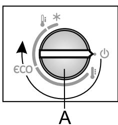
**Pour mettre l'appareil en marche,** tournez le bouton **A** dans le sens des aiguilles d'une montre.
