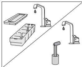
**3** Очистьте впускну трубку з пінним фільтром під проточною водою. Очистьте піну так, щоб не залишилось забруднень. Таким чином, ви будете впевнені, що прилад працює правильно і зберігає свіжий смак і запах їжі.
