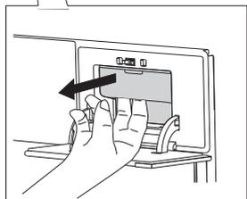
**2** Вийміть резервуар із корпусу, потягнувши за його вбудовану частину.
