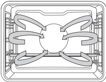
У цьому режимі працюють круговий нагрівач і вентилятор. За допомогою вентилятора, встановленого в задній частині духовки, гаряче повітря постійно циркулює навколо м'яса або випічки.
