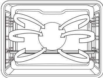
Вода з парогенератора потрапляє у верхню частину духовки у формі пари. Окрім цього, працюють круговий нагрівач з вентилятором, що забезпечує постійно циркуляцію гарячого повітря та пари.
