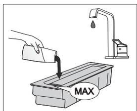
**3** Відкрийте кришку. Промийте резервуар водою. Зберіть резервуар. Налийте чисту воду до максимальної позначки на резервуарі, перш ніж його використовувати.
