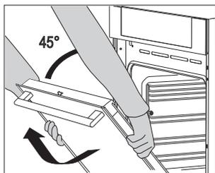
**3** Повільно зачиніть дверцята та залиште в положенні під кутом 45 градусів (відносно до положення повністю зачинених дверцят), а потім підніміть їх і повністю вийміть.
