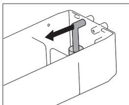
**2** Зніміть впускну трубку з кріплення для труб.
