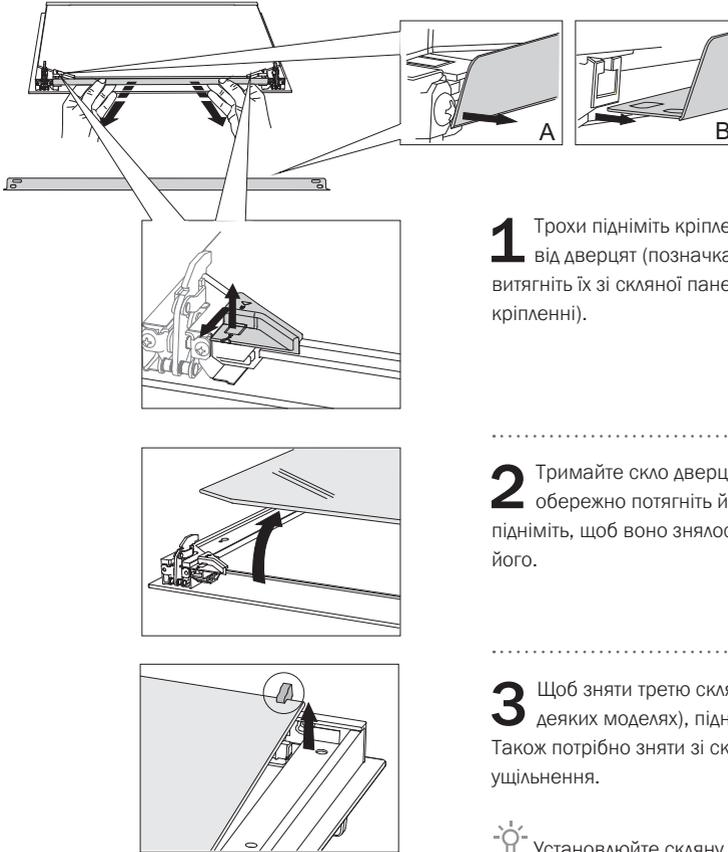
**1** Трохи підніміть кріплення ліворуч і праворуч від дверцят (позначка 1 на кріпленні) і витягніть їх зі скляної панелі (позначка 2 на кріпленні).
