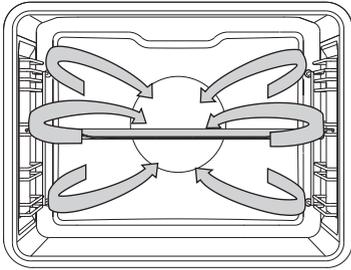
У цьому режимі працюють круговий нагрівач і вентилятор. За допомогою вентилятора, установленного в задній частині духовки, гаряче повітря постійно циркулює навколо м'яса, овочів або випічки.
