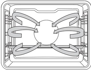
La résistance circulaire et le ventilateur fonctionnent simultanément. Le ventilateur situé au fond du four fait circuler autour du rôti ou du gâteau la chaleur produite par la résistance circulaire.
