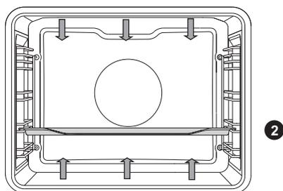
Topné články ve spodní části a ve stropě uvnitř trouby budou rovnoměrně vyzařovat teplo do vnitřku trouby.
