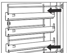
**2** Vyměňte vodicí lišty z otvorů v zadní části trouby.
