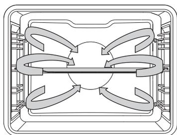
Kulatý ohřívač a ventilátor budou v provozu.
