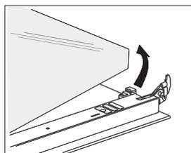
**2** Držte skleněný panel za spodní část, mírně jej nadzvedněte, aby se odpojil od úchytky, a panel vyjměte.
