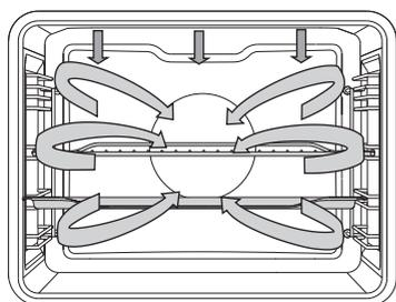
V režimu automatického pečení se zapne horní topné těleso v kombinaci s grilem a kruhovým topným tělesem. Tento režim je vhodný pro pečení všech druhů masa.
