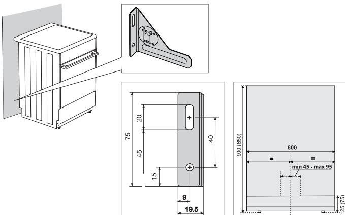
Οι διαστάσεις στην παρένθεση αφορούν τα ενωματωμένα μέτρα του βραχίονα στήριξης χωρίς την πρόσθετη υποστήριξη. Εάν το παρεχόμενο μέσω προστασίας της συσκευής από ανατροπή, δεν μπορεί να στερεωθεί σταθερά στον τοίχο με τις βίδες και τα ούπα που διατίθενται, χρησιμοποιήστε άλλα εξαρτήματα που θα μπορέσουν να συγκρατήσουν το στήριγμα με τέτοιον τρόπο ώστε να μην μπορεί να τραβηγτεί από τον τοίχο.
