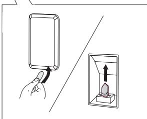
Χρησιμοποιήστε ένα κατσαβίδι για να ξεβιδώσετε το κάλυμμα του λαμπτήρα και να το αφαιρέσετε. Αφαιρέστε τον λαμπτήρα.
