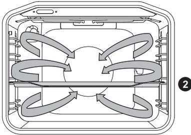
Gleichzeitig sind der Ringheizkörper und das Gebläse in Betrieb. Das Gebläse an der Rückwand des Garraums sorgt für ständiges Kreisen der heißen Luft um das Back-/Bratgut.
