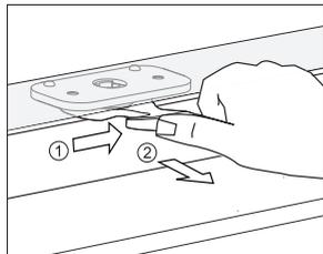
Öffnen Sie die Verriegelung, indem Sie sie mit dem Daumen nach rechts drücken und die Backofentür gleichzeitig zu sich ziehen.
