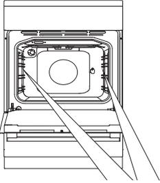
Entfernen Sie die Drahtführungen bzw. Teleskop-Ausziehführungen.
