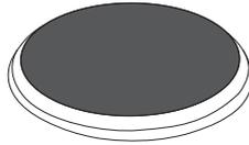
Schalten Sie die Kochplatte durch Drehen des entsprechenden Bedienungsknebels ein. Die Heizleistung der Kochplatten kann stufenweise von 1 – 6 oder stufenlos von 1 – 4 eingestellt werden.
