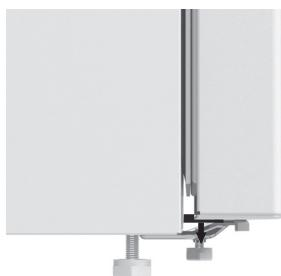
Distanshållare sitter i hörnen på dörrarna. Ta bort dem och sätt in medföljande pluggar i hålen (gäller endast vissa modeller).
