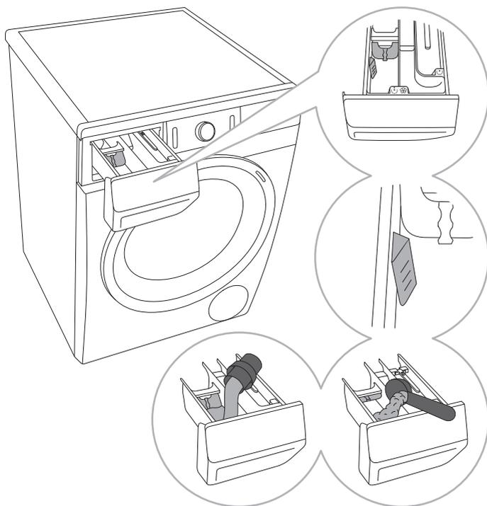
**1** В дозаторе моющих средств предусмотрена специальная пластинка, которая позволяет заливать в левое отделение дозатора ☺ (жидкие моющие средства).
