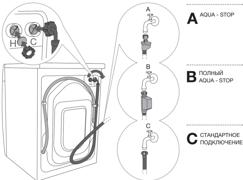
☼ Если ваша стиральная машина имеет подключение горячей и холодной воды, но вы хотите подключить ее только к источнику холодной воды, не устанавливайте трубу для горячей воды. Отверстие для подачи горячей воды, на задней панели стиральной машины, закройте прилагаемой крышкой.
