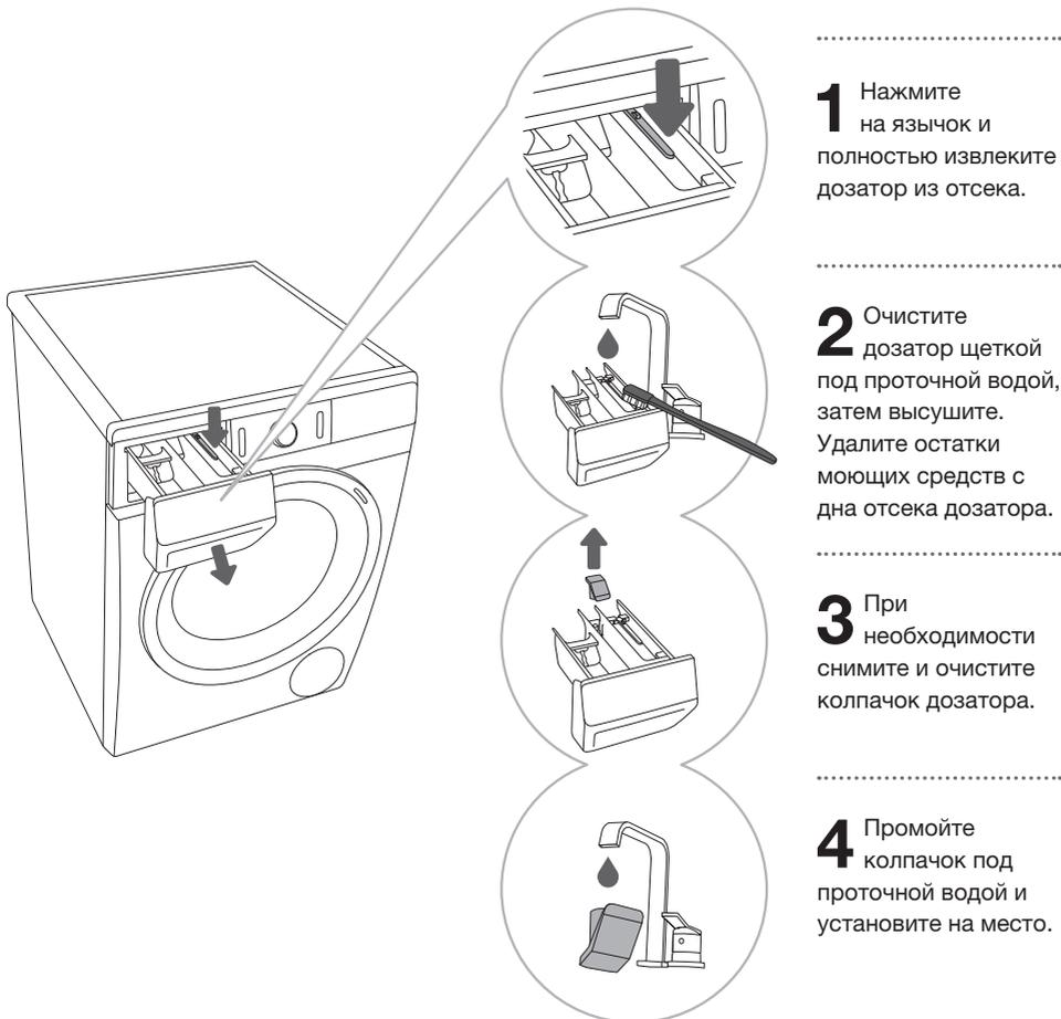
☹ Дозатор моющих средств не предназначен для мытья в посудомоечной машине.
