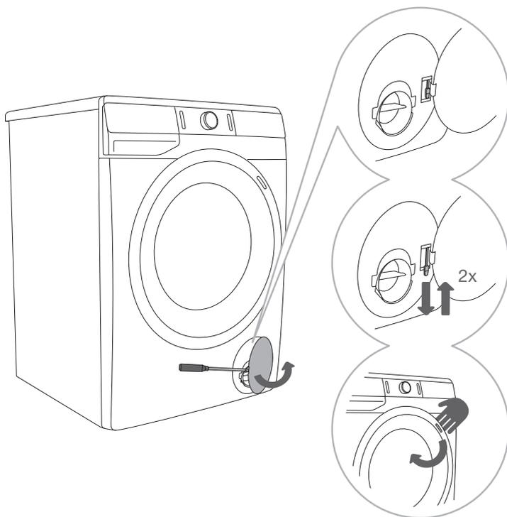
**1** Если программа прервана, откройте крышку фильтра с помощью плоской отвертки или подобного инструмента.
