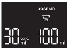
6. После определения загрузки, а также с учетом других параметров стирки на дисплее отобразится рекомендуемое количество порошкового или жидкого моющего средства в мл. Слева на дисплее отобразится рекомендуемое количество концентрированного, справа неконцентрированного порошкового или жидкого моющего средства.
