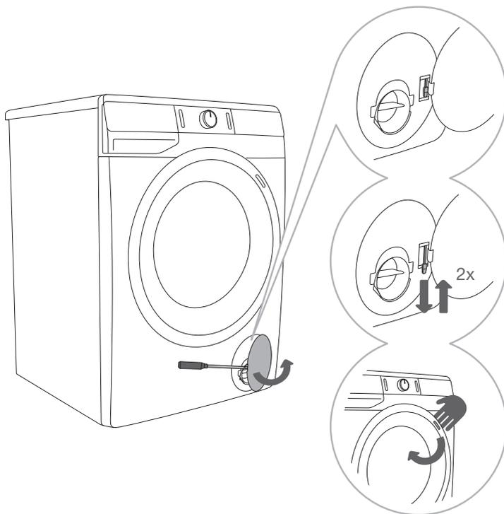
**1** Όταν το πρόγραμμα βρίσκεται σε παύση ή σε διακοπή, ανοίξτε το καπάκι του φίλτρου χρησιμοποιώντας ένα κατάλληλο εργαλείο (επίπεδο κατασβίδι ή παρόμοιο εργαλείο).
