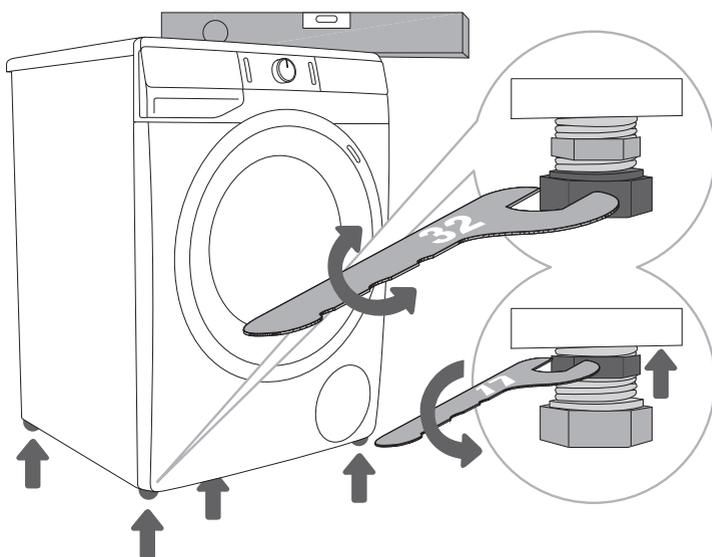
**1** Τοποθετήστε σε οριζόντια θέση τη συσκευή, στρέφοντας τα ρυθμιζόμενα πόδια.
