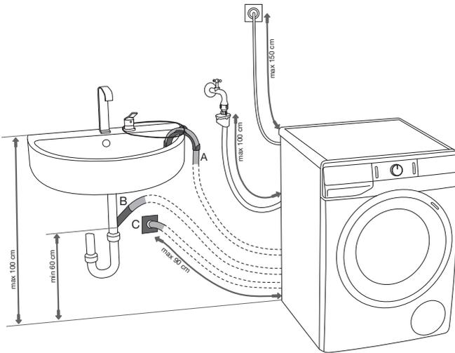
**A** Ο σωλήνας εκκένωσης νερού μπορεί να καταλήγει σε νιπτήρα ή μπανιέρα. Με ένα σπάγκο, στερεώστε το πλαστικό στήριγμα του σωλήνα (κούρμπα) έτσι ώστε να μην γλιστρήσει στο πάτωμα.
