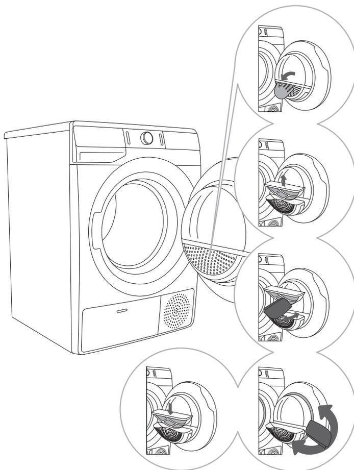
**1** Otvorite kućište filtera.
