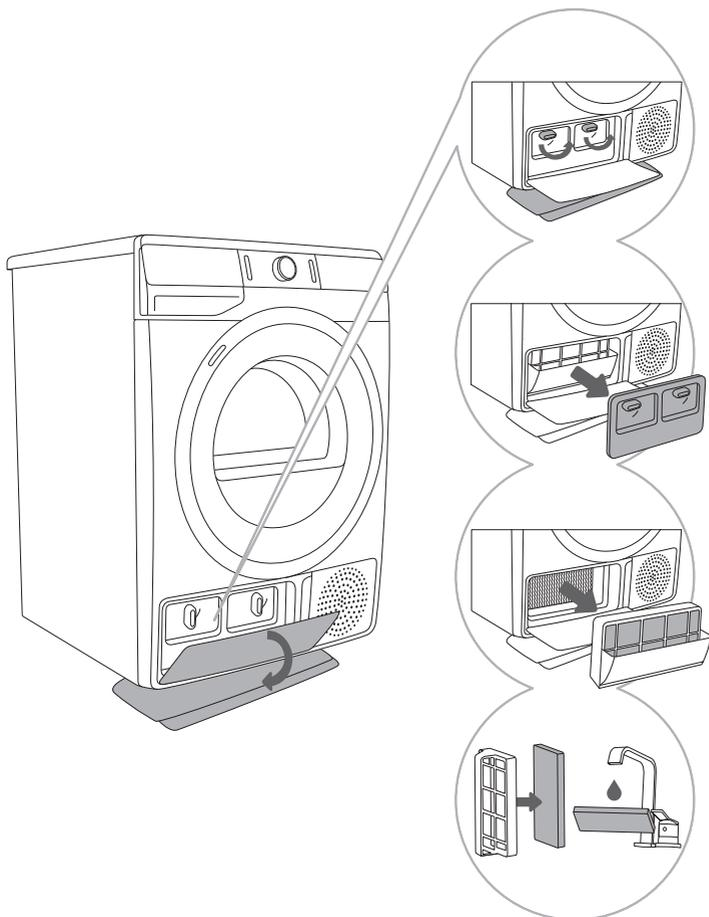
**1** Otvorite spoljni poklopac. Uхватите ručice na unutarnjem poklopcu i obrnite ih nagore. Skinite unutrašnji poklopac.
