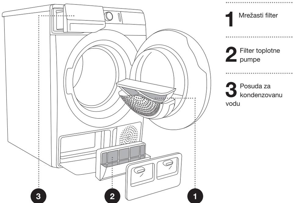
☀ Mašina za sušenje veša nikada ne sme raditi bez filtera, ili s oštećenim filterima jer bi inače prekomerna količina nakupljenih ostataka vlakana tkanina uzrokovala kvar ili nepravilan rad mašine za sušenje veša.
