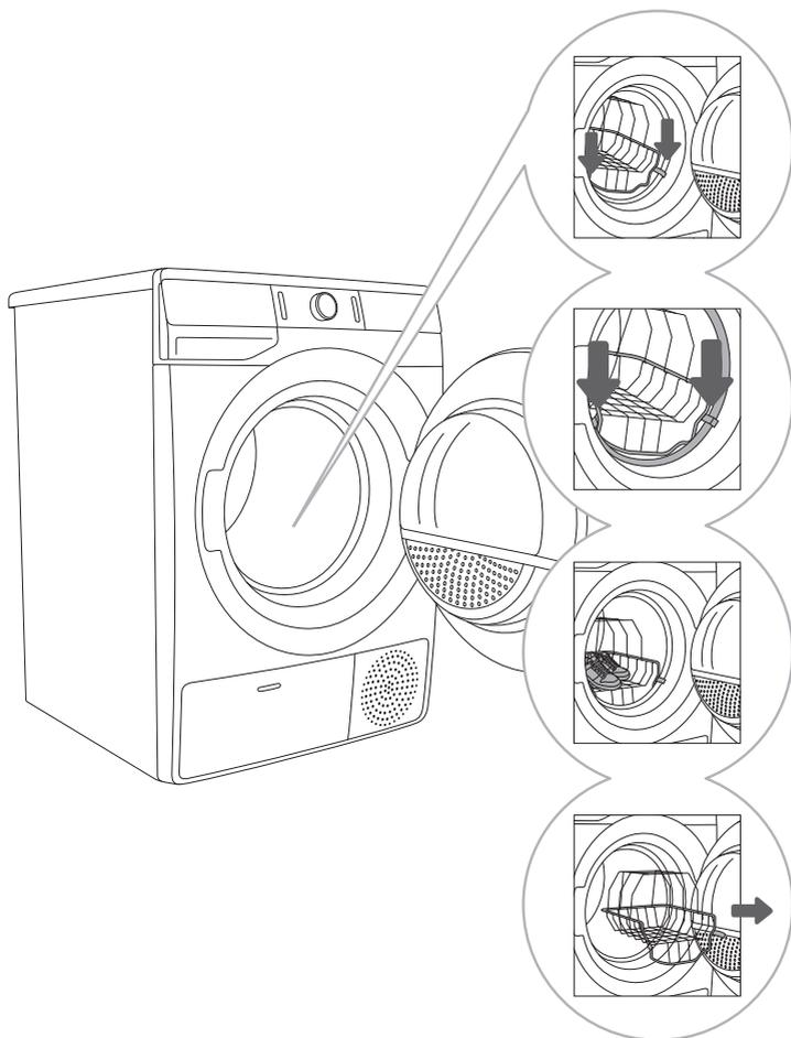
**1** Otvorite vrata mašine za sušenje veša i stavite košaru za sušenje.
