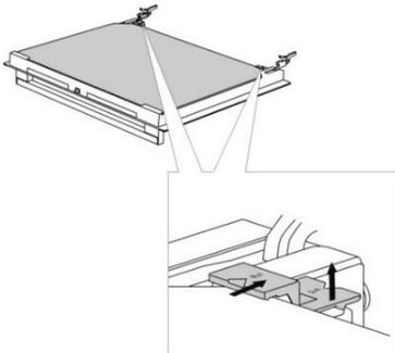
Heben Sie die Stützen auf der linken und rechten Seite der Backofentür leicht an (Markierung 1 auf der Stütze) und ziehen Sie sie von der Glasscheibe weg (Markierung 2 auf der Stütze).
