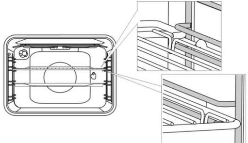
Wenn Ihr Gerät Teleskop-Auszieführungen besitzt, ziehen Sie diese zuerst bei einer Einschubebene heraus und legen Sie den Rost oder das Backblech darauf. Schieben Sie dieses danach mit der Hand in den Garraum.
