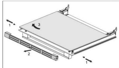
Schrauben Sie die Schrauben auf die Tür links und rechts und ziehen Sie die obere Leiste heraus. Sie können nun die Glasscheibe der Backofentür herausziehen.
