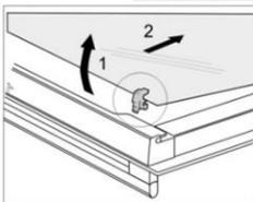
Halten Sie die Glasscheibe der Backofentür an der Unterkante; heben Sie sie leicht an, sodass sie nicht mehr in ihrer Halterung steckt und entfernen Sie sie.
