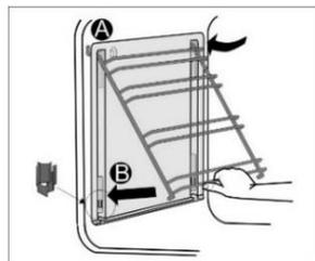
Platzieren Sie die Drahtführungen mit den katalytischen Einsätzen auf die oberen Öffnungen in den Seitenwänden des Garraums „A“.
