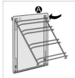
Montieren Sie die katalytischen Einsätze auf die Drahtführungen. Der obere Teil der Führungen muss in die oberen Öffnungen „A“ der katalytischen Einsätze montiert werden.
