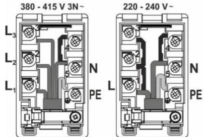
Installationsseitig ist eine Trennvorrichtung mit mindestens 3 mm oder mehr Kontaktabstand anzubringen, die alle Polleiter unterbricht.
