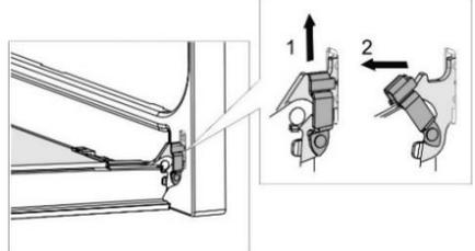
3. Schließen Sie langsam die Backofentür, heben Sie sie leicht an und ziehen Sie sie aus den beiden Scharnieren des Geräts heraus.
