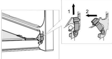
3. Медленно закрывайте дверцу, немного приподнимите ее и извлеките из гнезд шарниров.
