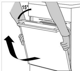
Следите, чтобы фиксаторы шарниров после установки дверцы были надежно закрыты в гнездах шарниров, иначе основной шарнир может резко захлопнуться из-за натяжения мощной пружины. Опасность травм и повреждений!
