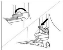
3. Медленно закрывайте дверцу, пока фиксаторы не упрутся в прорези на дверце. Приблизительно при 15° (относительно закрытой дверцы) дверцу немного приподнимите и извлеките из гнезд шарниров.
