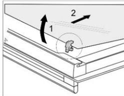
Возьмите стекло дверцы за нижний край, немножко приподнимите, чтобы оно освободилось из фиксаторов, и снимите.
