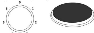
Конфорки включаются поворотом переключателя. Степень нагрева конфорок устанавливается ступенчато.
