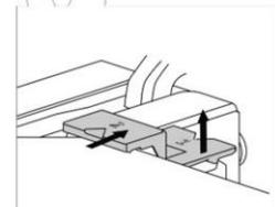
Немного приподнимите фиксаторы с левой и правой стороны дверцы (символ 1 на фиксаторе) и потяните в стороны от стекла (символ 2 на фиксаторе).
