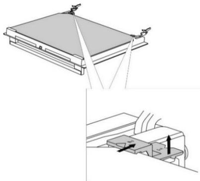
Трохи підніміть кріплення зліва і справа від дверцят (відмітка 1 на кріпленні) і витягніть їх зі скляної панелі (відмітка 2 на кріпленні).
