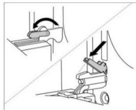
3. Повільно зачиняйте дверцята духовки, доки фіксатори не співпадіть із петлями на бокових планках дверцят. За кута 15° (відносно закритого положення) злегка прикрийте дверцята й витягніть їх з обох петель на приладі.
