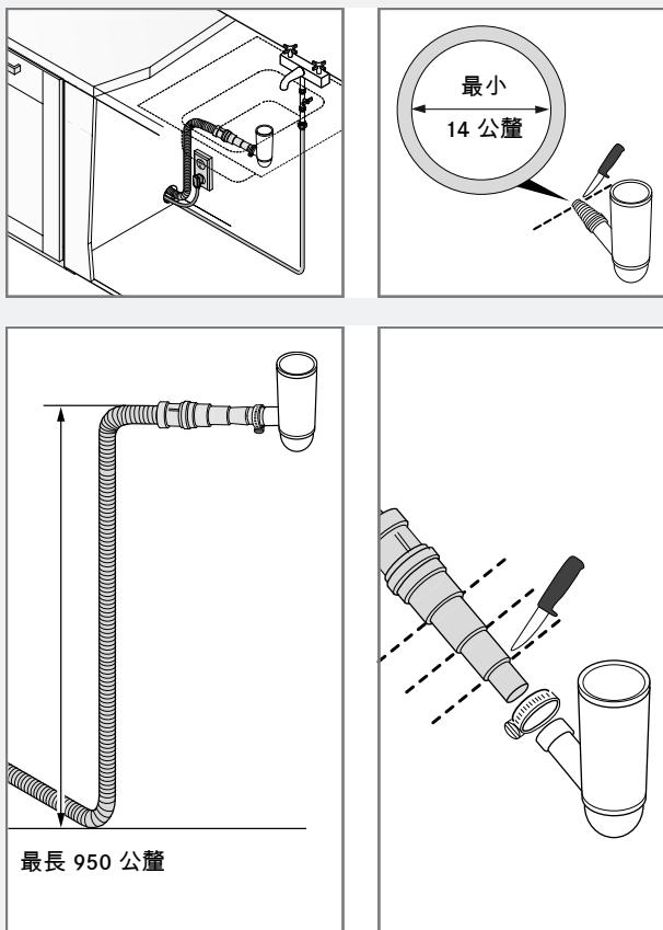
排水管也可以連接到水槽底部排水孔接頭。排水孔接頭的內徑至少要有 14 公釐。
