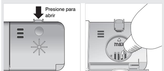
1. Abra la tapa del depósito del abrillantador.
