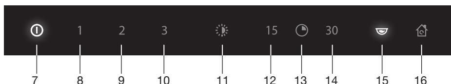
7. Кнопка вкл./выкл. вытяжки; переключает вытяжку в режим ожидания или отключает полностью.
