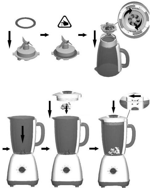
1. Posizionare la guarnizione di tenuta attraverso la lama con la base.
