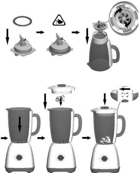
1. Helyezze el a tömítőgyűrűt a pengeszerkezet körül.
