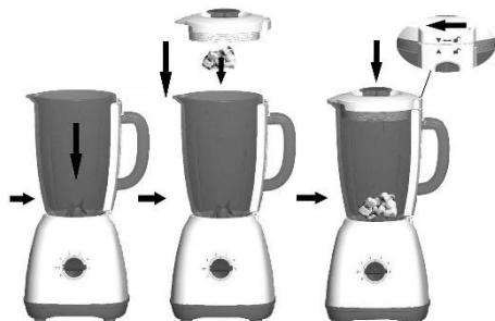
1. Sett pakningsringen til beholderen over miksekniven.
