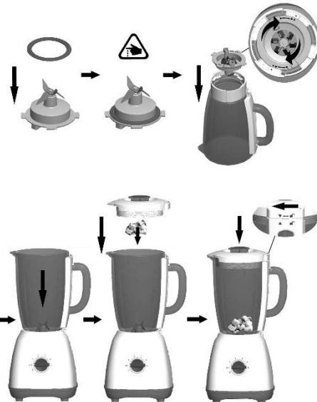
1. Sätt tätningsringen över mixerkniven.
