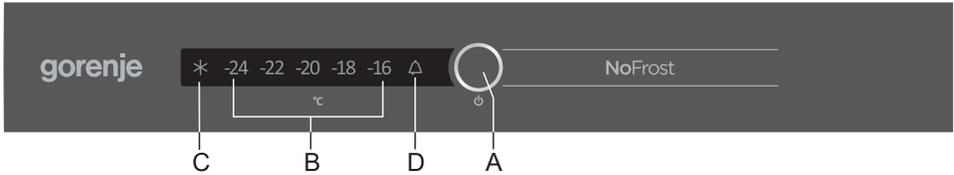
**A** Apparat på/av, temperaturinställningar och extra funktionsknapp
