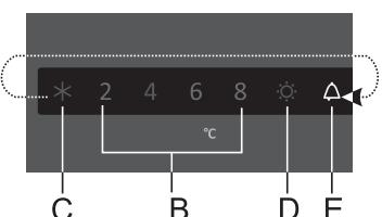
U slučaju previše povećane temperature u uređaju, uključuje se zvučni alarm (isprekidan ton zvuka) i bljeska simbol **E**.
