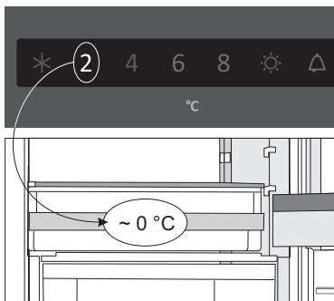
Da bi temperatura u pretincu **ZeroZone** bila oko  $0\text{ }^{\circ}\text{C}$ , preporučujemo da temperaturu hladnjaka podesite ispod  $4\text{ }^{\circ}\text{C}$ . Temperatura u pretincu **ZeroZone** može se spustiti i ispod  $0\text{ }^{\circ}\text{C}$ , stoga namirnice osjetljive na zamrzavanje premjestite u gornje predjele hladnjaka.
