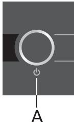
Ako su vrata rashladnog prostora (hladnjaka) otvorena duže od 2 minute, uključi se zvučni alarm (ponavljajuće piskanje). Ako ga ne isključite, zvučni će se alarm nakon 10 minuta isključiti automatski. Aparat će i dalje raditi normalno, kao da su vrata zatvorena.
