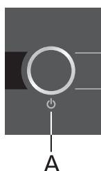
**Uključenje uređaja:** uređaj upućujete u rad pritiskom na tipku **A** koju držite pritisnutu 3 sekunde.
