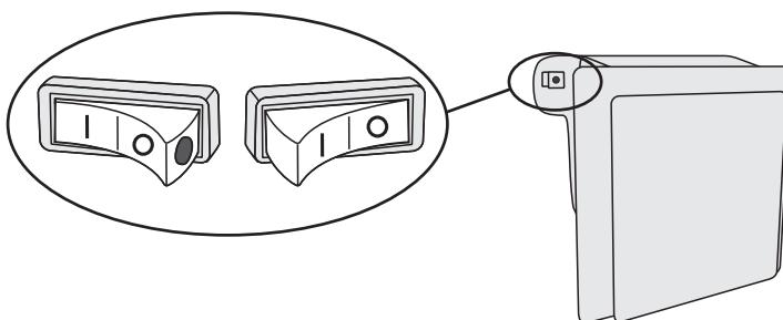
Kada je ionizator uključen, na prekidaču je vidljiva crvena točka.
