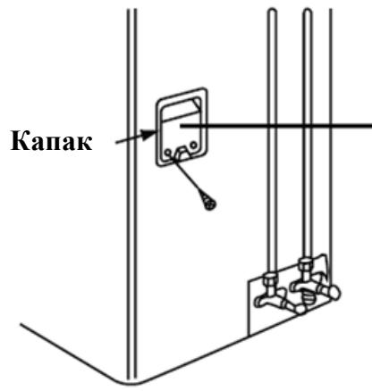
Електрическата схема се намира от вътрешната страна на кабелния капак на външното тяло.
