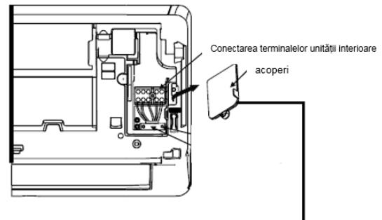
Schemă de conexiuni este situat pe partea interioară a unității interioare acoperi.
