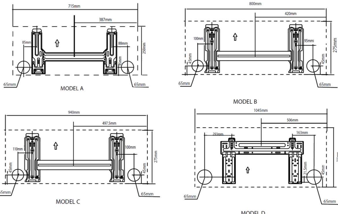
Слика 5. Препоручљиви положаји рупа за гасно и електрично повезивање
