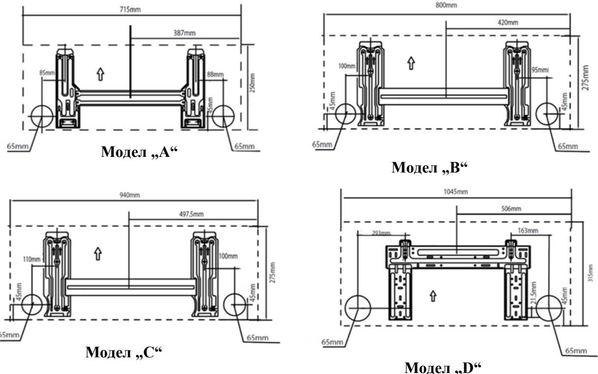
**Фиг. 5:** Препоръчително расположение на отворите за газовите тръби и електрическото окабеляване
