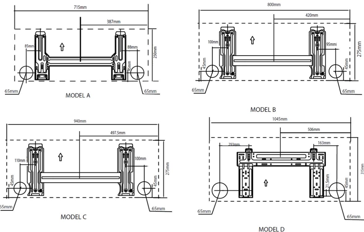
Billede 5: Anbefalet huller til gasrør og elektriske ledninger
