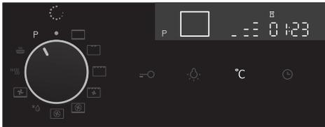
**2** Wählen Sie die Reinigungsstufe 2 P aus. Berühren Sie die TASTE zur TEMPERATUREINSTELLUNG und drehen Sie den EINSTELLKNEBEL (-/+).
