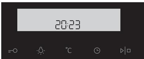
**2** Bestätigen Sie die Einstellung durch Drücken der Taste START/STOPP. Wenn Sie innerhalb der nächsten drei Sekunden keine Taste betätigen, wird die Einstellung automatisch gespeichert.
