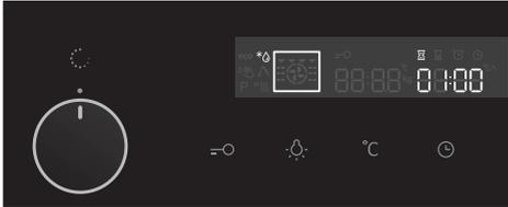
Drehen Sie den WAHLKNEBEL für die Betriebsart auf die Position „AUFTAUEN“. Auf dem Display wird die ZEIT angezeigt, die Sie ändern können. Drücken Sie die START-Taste.
