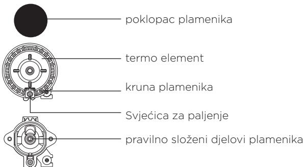
**Upozorenje:** poklopci plamenika emajlirani su u crnoj boji. Zbog visokih temperatura nije moguće izbjegći promjene u boji, što inače niti najmanje ne utječe na djelovanje plamenika.
