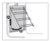
Cuelque los paneles con las guías Conectadas usando los orificios provistos v tire hacia arriba.
