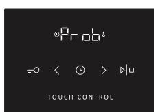
Όταν συνδεθεί το θερμόμετρο κρέατος, επιλέξτε το επιθυμητό πρόγραμμα μαγειρέματος και θερμοκρασίας. Η ένδειξη "Prob" θα εμφανιστεί στην οθόνη για 3 δευτερόλεπτα. Στη συνέχεια, το εικονίδιο (θερμόμετρο κρέατος) θα εμφανιστεί στην οθόνη και θα παραμένει εκεί για όσο διάστημα ο αισθητήρας είναι συνδεδεμένος. Όλες οι άλλες ενεργές λειτουργίες θα ακυρωθούν ή θα διαγραφούν.
