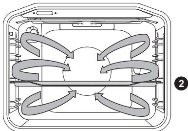
Λειτουργεί η κυκλική αντίσταση και ο ανεμιστήρας. Ο ανεμιστήρας στο πίσω τοίχωμα της κοιλότητας του φούρνου εξασφαλίζει τη συνεχή κυκλοφορία του ζεστού αέρα γύρω από το ψητό ή τις ζύμες.
