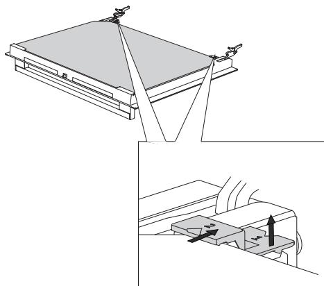
**1** Ανασηκώστε ελαφρώς τα στηρίγματα στην αριστερή και δεξιά πλευρά της πόρτας (ένδειξη 1 στο στήριγμα) και τραβήξτε τα από τον υαλοπίνακα (ένδειξη 2 στο στήριγμα).
