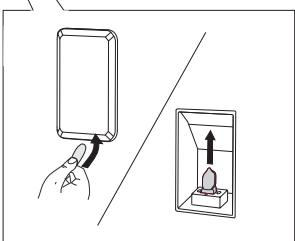
Χρησιμοποιήστε ένα κατσαβίδι για να ξεβιδώσετε το κάλυμμα του λαμπτήρα και να το αφαιρέσετε.
