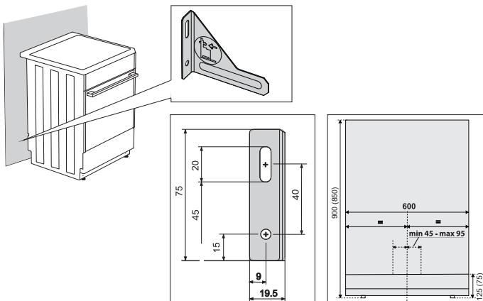
Размерите в скоби представляват размерите за вграждане на поддържащата скоба без допълнителна опора. Ако приложният елемент за защита на уреда от преобръщане не може да бъде закрепен здраво към стената с приложените винтове и дюбели, използвайте други приспособления за закрепване на скобата по такъв начин, че да не може да бъде изтеглена от стената.
