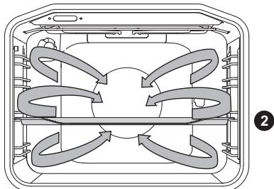
При тази функция ще работят кръговият нагревател и вентилаторът. Монтираният на задната стена на фурната вентилатор осигурява непрекъсната циркулация на горещ въздух около ястието или тестените изделия.
