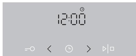
**1** Настройте часовника с натискане на бутона < или > и потвърдете настройката с натискане на бутона
