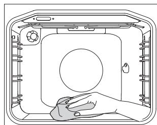
**1** Завъртете КОПЧЕТО ЗА ИЗБОР НА СИСТЕМА НА ГОТВЕНЕ в положение за почистване с вода. 2. Задайте КОПЧЕТО ЗА ТЕМПЕРАТУРАТА в положение 70 °C.
