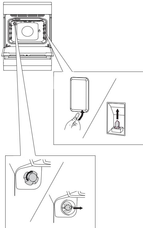
S ploščatim izvijačem sprostite pokrov žarnice in ga odstranite. Izvlecite žarnico.
