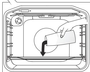
**2** V steklen pekač vlijte 0,6 l vode in ga vstavite v spodnje vodilo.
