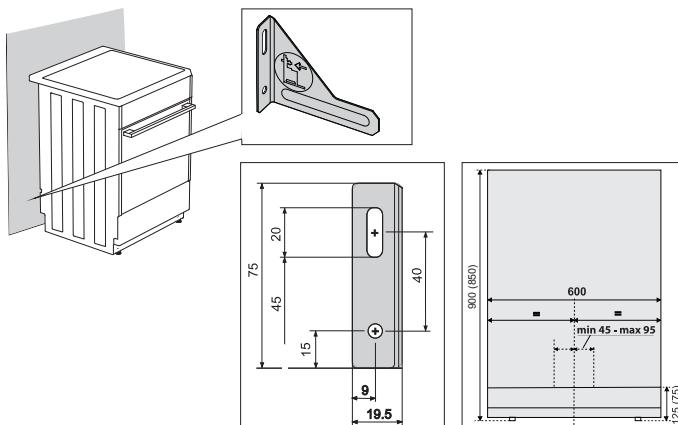
Dimenzijs v oklepaju predstavljajo vgradne mere kotnega nosilca brez dodatnega podstavka. Če s priloženimi vijaki in vložki ni mogoče trdno pritrdirti priložene zaščite pred prevračanjem aparata na vašo steno, priskrbite ustrezno okovje ter ostale elemente za pritrdiritev kotnega nosilca na tak način, da ga ni mogoče izpuliti.
