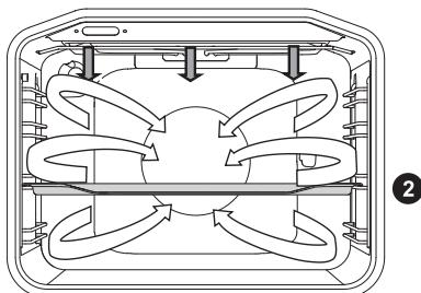
Pri tem sistemu istočasno delujeta infra grelo in ventilator. Primeren je za pečenje mesa, rib, zelenjave.
