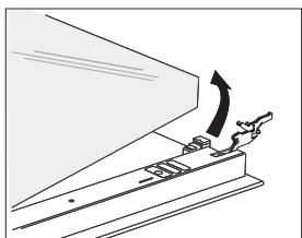
**2** Steklo vrat primite na spodnjem robu, ga rahlo privzdignite, da se iztakne iz nosilca in odstranite.
