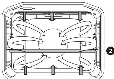
Funkcija omogoča nežno, počasno in enakomerno pečenje, zato hrana ostane mehka in sočna. Primerna je za pečenje mesa, rib in peciva na enem nivoju.
