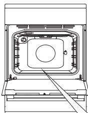
**1** Obrnite GUMB ZA IZBIRO SISTEMA PEČENJA na Aqua clean. GUMB za TEMPERATURO nastavite na 70 °C.
