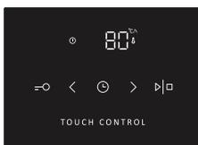
Auf dem Display blinkt die eingestellte Temperatur 80°C, die Sie mit den Tasten i < und > in einem Temperaturbereich zwischen 30°C und 99°C ändern können.
