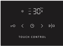
Starten Sie das Programm nach Auswahl der Temperatur durch längeres Drücken der Taste START/STOPP. Während des Betriebs blinken auf dem Display abwechselnd die eingestellte Temperatur und die aktuelle Temperatur. Links wird die Temperaturskala angezeigt.
