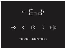
Sobald die eingestellte Temperatur des Fleischkerns erreicht ist, schaltet sich der Backofen automatisch aus. Ein akustisches Signal ertönt und auf dem Display erscheint das Wort „End“. Der Bratvorgang mit Fleischsonde ist beendet.
