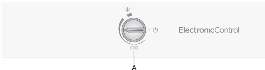
**A** Butonul A pentru setări de temperatură, trecerea aparatului în poziția pornit/oprit (on/off) și activarea funcției de super-congelare
