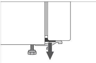
Colțurile ușilor sunt prevăzute cu distanțiere protectoare. Acestea trebuie îndepărtate și înlocuite cu suporturile atașate, care trebuie introduse în orificiile respective (doar în cazul anumitor modele).
