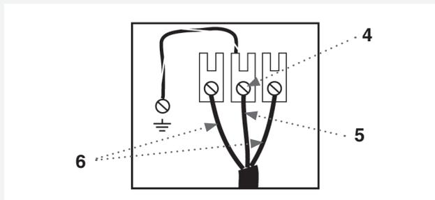
5. Reliez le fil neutre (blanc) du cordon électrique à la vis centrale de couleur argent de la borne. Serrez la vis.
