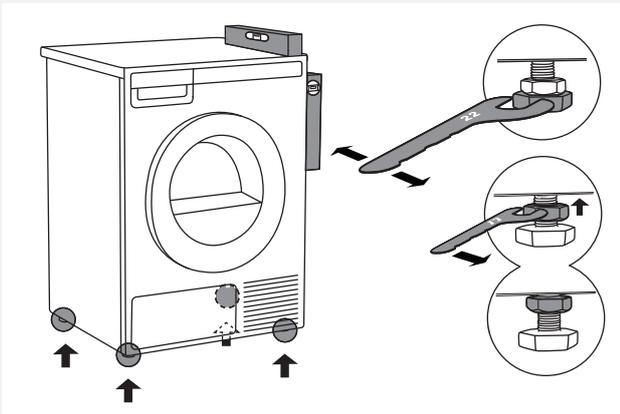
Installez le sèche-linge de façon à ce qu'il soit stable. Utilisez un niveau à bulles pour mettre l'appareil à niveau dans le sens horizontal et le sens vertical en tournant les pieds réglables avec une clé plate de 22 mm (0.87") (15 mm (0.59") maxi en hauteur). Puis serrez fermement les contre-écrous avec une clé plate de 17 mm (0.67") en les tournant vers le fond du lave-linge ↑.
