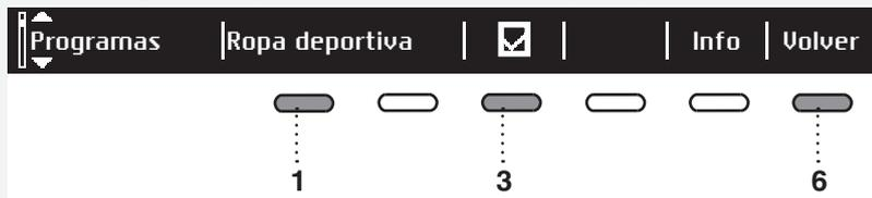
Presione la tecla 1, para que aparezca . Con el selector o la tecla 1 seleccionar el programa. Lo visualizado se determina con la tecla 3: encendido  /apagado .
