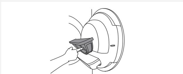
**3** Con cuidado retirar el recubrimiento de fibras e hilos del filtro de malla.
