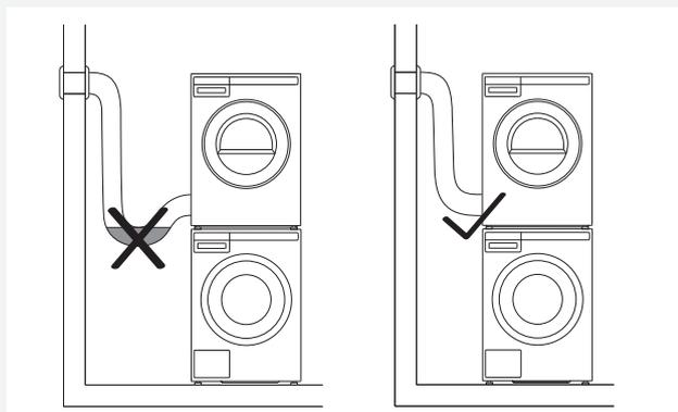
💡 Si cet appareil est installé dans un pays au climat chaud (77° F et plus) et très humide, ne positionnez pas le boyau d'évacuation de l'air vers le haut.
