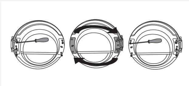
**6** Démontez la charnière (à gauche) et la serrure (à droite), intervertissez leur emplacement et revissez-les (charnière sur la droite et serrure sur la gauche).
