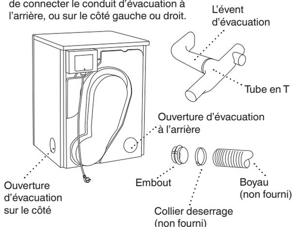
N'utilisez pas de vis ni de fixations dépassant à l'intérieur du conduit pour éviter que des fibres et peluches ne s'y accrochent.
