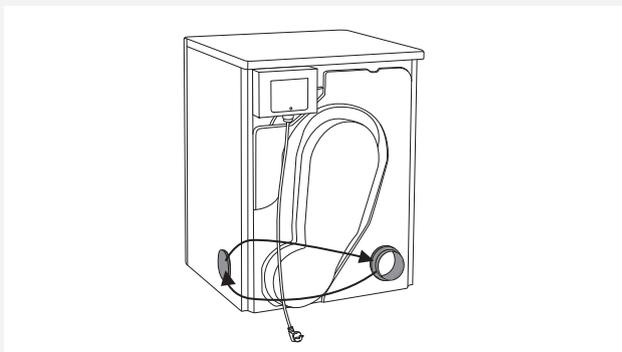
Les sècheuses ASKO ont une bouche de ventilation en forme de 'T' qui vous permet de connecter le conduit d'évacuation à l'arrière, ou sur le côté gauche ou droit.
