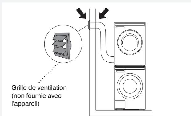
⚠ Ne placez jamais le conduit d'évacuation dans une cheminée, un mur, le plafond ou autre espace fermé d'un édifice. Utilisez seulement un grillage de ventilation en métal. Si le boyau est raccordé à une ouverture dans le mur, un grillage de ventilation devra être installé pour empêcher le reflux de l'air froid. Installez le grillage de la ventilation à l'extérieur du mur.
