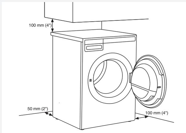
💡 Le sèche-linge ne doit pas toucher le mur ni les meubles adjacents. Pour un séchage optimal, respectez la distance entre l'appareil et le mur indiquée sur la figure.
