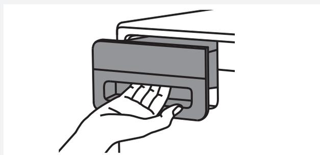
Tire del dispensador hasta su posición final. En el menú principal se visualizará el ajuste ADS.
