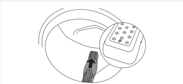
**5** Coloque el bateaguas en el agujero de montaje de modo que la letra F esté orientada hacia Ud. Cerciérese de que el bateaguas siente bien en los agujeros de fijación. Empújelo hacia el interior del tambor (como lo indica la flecha en la figura), hasta que encaje en su posición.
