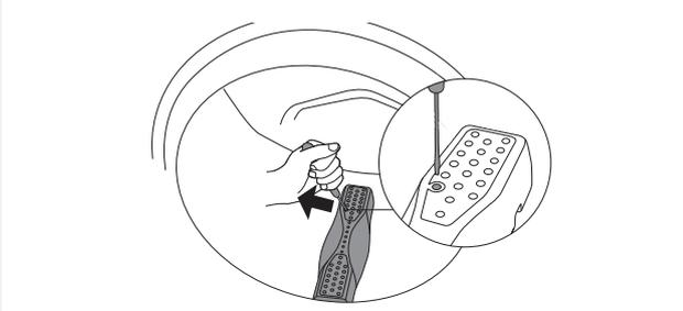
**1** Coloque un destornillador o un objeto parecido en el agujero en el bateaguas y empujelo con cautela hacia la izquierda.
