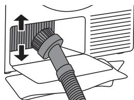
**6** Очищайте пластины теплообменника пылесосом и насадкой с мягкой щеткой. Не нажимая, аккуратно перемещайте насадку вдоль металлических пластин сверху вниз. Большое давление может повредить или изогнуть пластины теплообменника.
