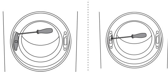
**3** С помощью отвертки снимите заглушку замка дверцы и открутите винт на замке.
