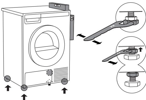
Установите машину в стабильном положении и выровняйте по строительному уровню, вращая регулируемые ножки ключом номер 22 (макс. 15 миллиметров). Затем закрутите контргайки ключом номер 17 по направлению к дну машины .
