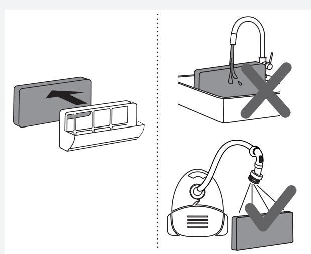
**4** Извлеките губчатый фильтр из корпуса фильтра. Очистите пылесосом с использованием мягкой щетки-насадки. Вставьте чистый губчатый фильтр в корпус фильтра.
