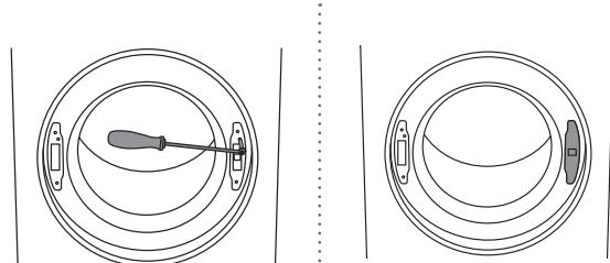
**5** Закрутите винт на замке дверцы и установите заглушку.
