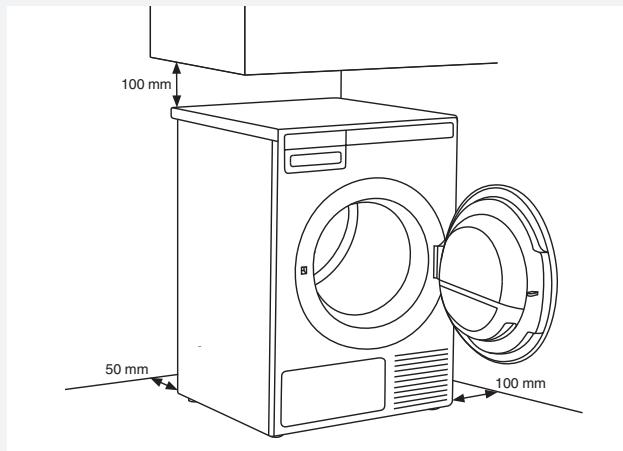
Сушильную машину нельзя устанавливать вплотную к стене и мебели. Для оптимальной работы машины соблюдайте расстояния от стены, как показано на рисунке.
