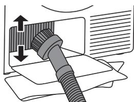
**6** Pode limpar o pó e as sujidades presentes nas lâminas metálicas do permutador de calor com um aspirador equipado de uma escova flexível. Desloque suavemente a escova apenas no sentido das lâminas metálicas, de cima para baixo e sem pressionar. Uma pressão excessiva pode danificá-las ou torcê-las.
