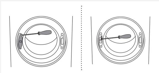
**3** Rimuovere la copertura della serratura dell'oblò con un cacciavite e svitarne la vite.
