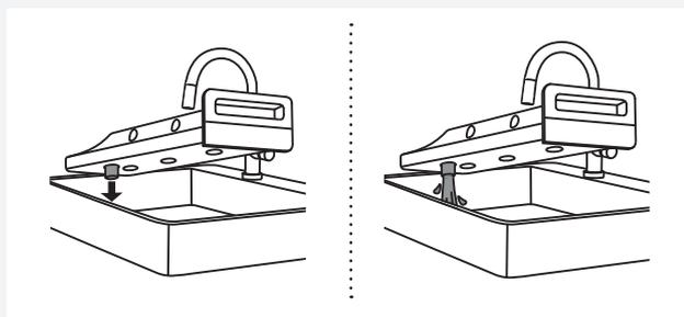
**2** Fare uscire l'acqua attraverso il beccuccio di scarico dell'acqua di condensa.
