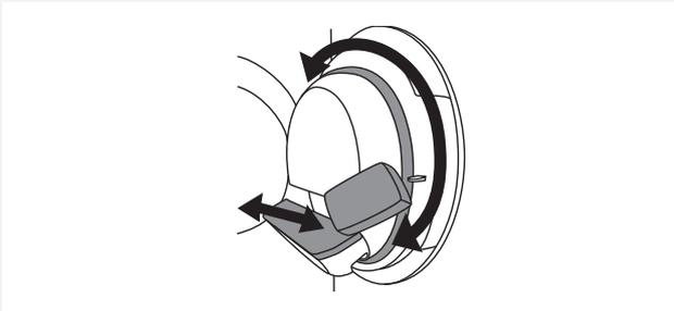
Se necessario pulite anche il telaio del filtro e la guarnizione dello sportello.
