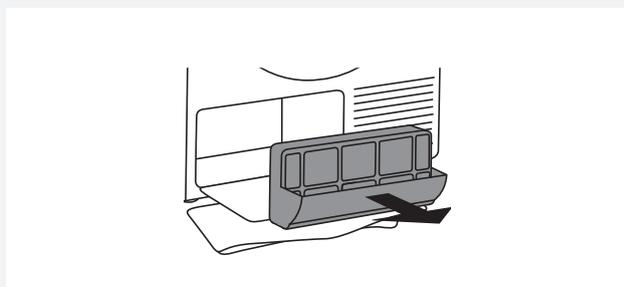
**3** Utilizzando la maniglia estrarre il filtro della pompa di calore.
