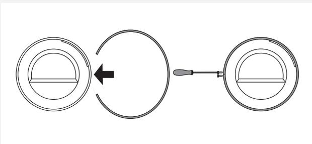
**9** Ruotare l'anello dell'oblò di 180°, installarlo sull'oblò e avvitarlo.
