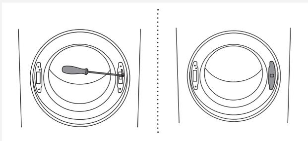
**5** Avvitare la vite nella serratura dell'oblò.
