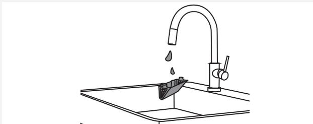
**3** Pulire bene il filtro sotto l'acqua corrente. Se necessario, pulire anche l'alloggiamento del filtro.
