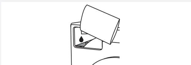
**2** Versare lentamente l'acqua del filtro del generatore di vapore.
