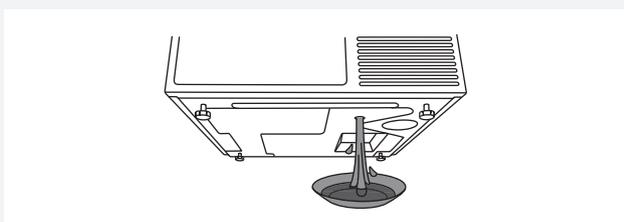
**4** Quando il contenitore si è completamente svuotato, rimettere il tappo (senza il tappo, durante l'asciugatura, si verificherà una perdita di acqua sul pavimento).
