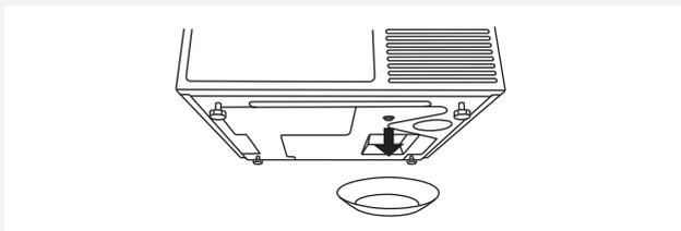
**2** Il tappo di scarico del contenitore del generatore di vapore si trova sul lato inferiore (davanti a sinistra).
