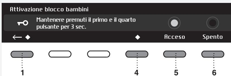
Per attivare la funzione premere ON per disattivare premere OFF. Quando la Blocco bambini (Child Lock) è attivata, non è possibile modificare nessuna funzione.
