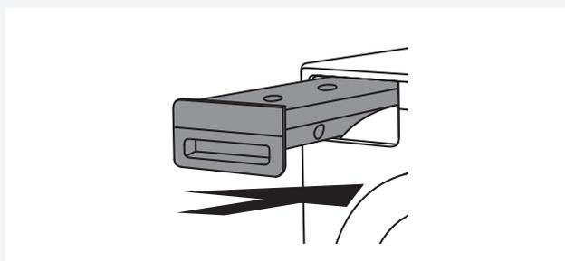
**3** Risistemare il contenitore acqua di condensa nel suo alloggiamento.
