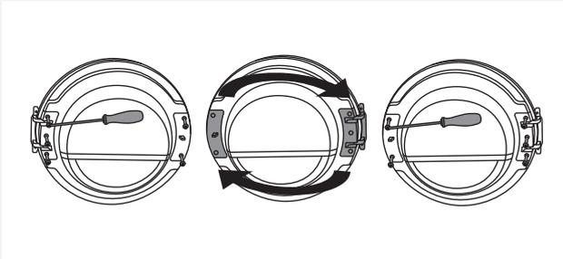
**6** Svitare la cerniera dell'oblò (a sinistra) e il blocco serratura dell'oblò (a destra), scambiarli e riavvitarli (la cerniera dell'oblò sul lato destro e il blocco serratura dell'oblò sul lato sinistro).
