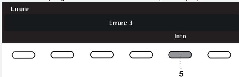
Premendo a lungo il tasto 5 INFO appare sul display l'indicazione di errore.
