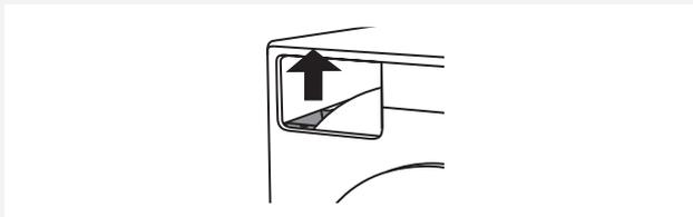
**2** Estrarre il filtro dall'alloggiamento del contenitore per l'acqua condensata.
