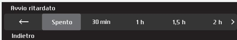
Col tasto per selezionare il programma si può avanzare da 30 min a 6 ore, ad intervalli di 30 minuti, poi da 6 ore fino a 24 ore con intervalli di 1 ora.
