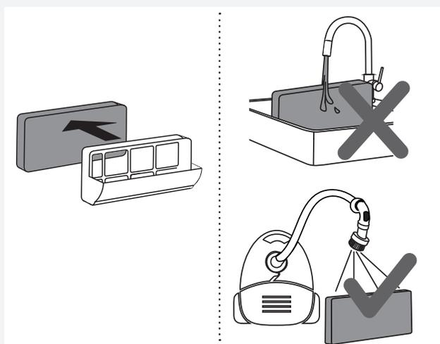
**4** Estrarre il filtro in schiuma dall'alloggiamento. Pulirlo con un'aspirapolvere e l'accessorio spazzola morbida. Reinstallare il filtro in schiuma pulito nell'alloggiamento del filtro.
