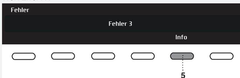
Durch längeres Drücken der Taste 5 INFO wird auf dem Display die Beschreibung des Fehlers angezeigt.
