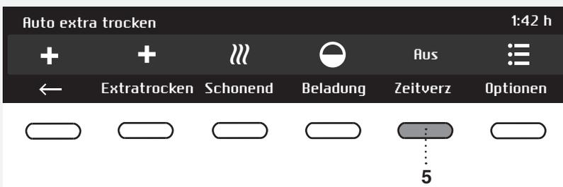
Falls Sie die Einschaltverzögerung (Startzeitvorwahl) widerrufen und sofort mit dem Trocknen beginnen möchten, drücken Sie die Taste 5 "Aus" „Widerruf“ (Skip Delay).
