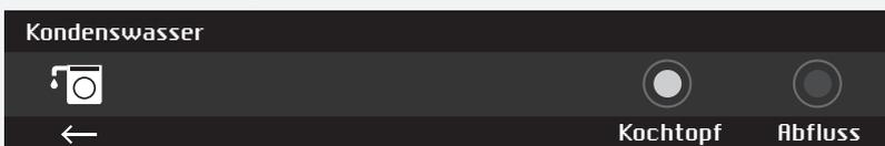
Mit dem Programmwahlknebel oder den Tasten können Sie unter folgenden Möglichkeiten auswählen: "Kochtopf (Tank)" - Ablauf des Kondenswassers in den Kondenswasserbehälter "Abfluss (Drain)" - Ablauf des Falls Sie sich für die Option „Drain“ entschieden haben", muss ein Ablaufrohr montiert werden (siehe Kapitel „AUFSTELLUNG UND ANSCHLUSS/Ablauf des Kondenswassers“).
