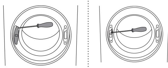
**3** С помощью отвертки снимите заглушку замка дверцы и открутите винт на замке.
