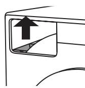
**2** Выньте фильтр из отсека емкости для конденсата.
