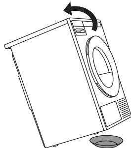
**1** Отодвните машину от стены приблизительно на 40 сантиметров и наклоните назад.
