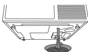
**4** После того как вода вытечет, закройте крышку (если не закрыть крышку, при сушке вода будет вытекать на пол).
