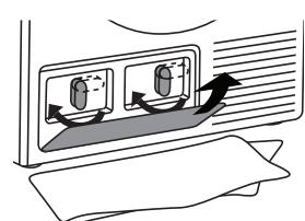
**8** Установите на место внутреннюю крышку и поверните рукоятки по часовой стрелке в вертикальное положение. Закройте наружную дверцу.
