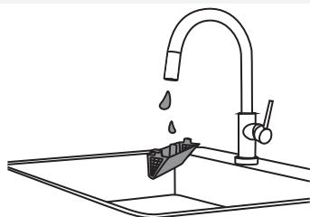
**3** Промойте фильтр под проточной водой. При необходимости очистите место установки фильтра.
