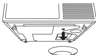
**2** Отверстие для слива емкости парогенератора находится в днище прибора с передней стороны слева.
