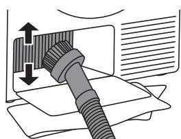
**6** Очищайте пластины теплообменника пылесосом и насадкой с мягкой щеткой. Не нажимая, аккуратно перемещайте насадку вдоль металлических пластин сверху вниз. Большое давление может повредить или изогнуть пластины теплообменника. Рекомендуется очищать теплообменник не реже одного раза в год.
