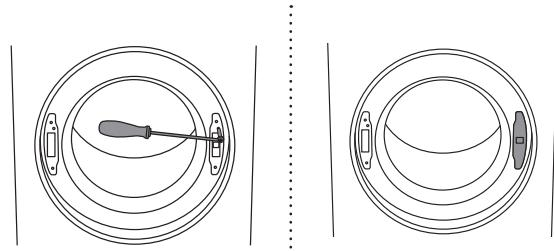
**5** Закрутите винт на замке дверцы и установите заглушку.
