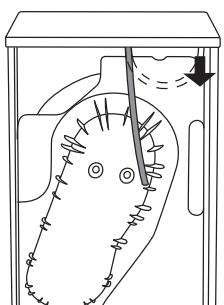
**1** Снимите короткую трубку с патрубка (A).
