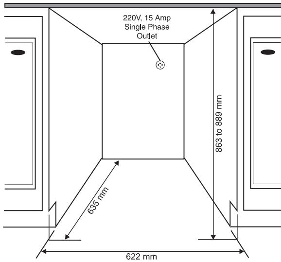
Сушильные машины Asko можно устанавливать в нишу или под столешницу высотой не менее 864 миллиметра. Вокруг машины необходимо оставить расстояние 12 миллиметров, задний край крышки машины должен находиться на расстоянии не менее 25 миллиметров от стены. Ширина проема должна составлять не менее 622 миллиметра.
