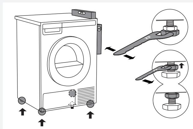
Установите машину в стабильном положении и выровняйте по строительному уровню, вращая регулируемые ножки ключом номер 22 (макс. 15 миллиметров). Затем закрутите контргайки ключом номер 17 по направлению к дну машины ↑.
