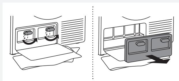
**2** Откройте панель конденсатора, повернув обе рукоятки вверх.
