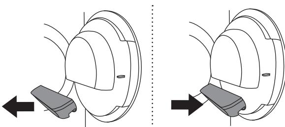
Если вы при очистке случайно сняли **ПОЛНОСТЬЮ** ворсовый сетчатый фильтр с корпусом, установите его обратно на место.
