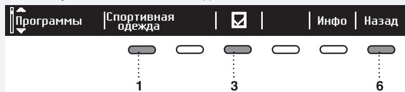
Нажмите кнопку 1, чтобы на дисплее появились стрелки . Выберите программу переключателем программ или кнопкой 1. Вывод на дисплей устанавливается кнопкой 3: вкл.  / выкл. .
