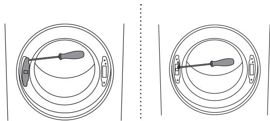
**3** С помощью отвертки снимите заглушку замка дверцы и открутите винт на замке.
