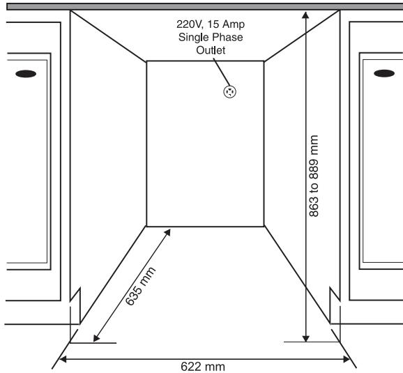
Сушильные машины Asko можно устанавливать в нишу или под столешницу высотой не менее 864 миллиметра. Вокруг машины необходимо оставить расстояние 12 миллиметров, задний край крышки машины должен находиться на расстоянии не менее 25 миллиметров от стены. Ширина проема должна составлять не менее 622 миллиметра.
