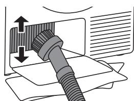
**6** Очищайте пластины теплообменника пылесосом и насадкой с мягкой щеткой. Не нажимая, аккуратно перемещайте насадку вдоль металлических пластин сверху вниз. Большое давление может повредить или изогнуть пластины теплообменника. Рекомендуется очищать теплообменник не реже одного раза в год.
