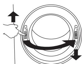
**4** Подтолкните замок вверх и снимите. Переставьте на другую сторону и для фиксации замка надавите на него вниз.
