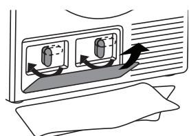
**8** Установите на место внутреннюю крышку и поверните рукоятки по часовой стрелке в вертикальное положение. Закройте наружную дверцу.
