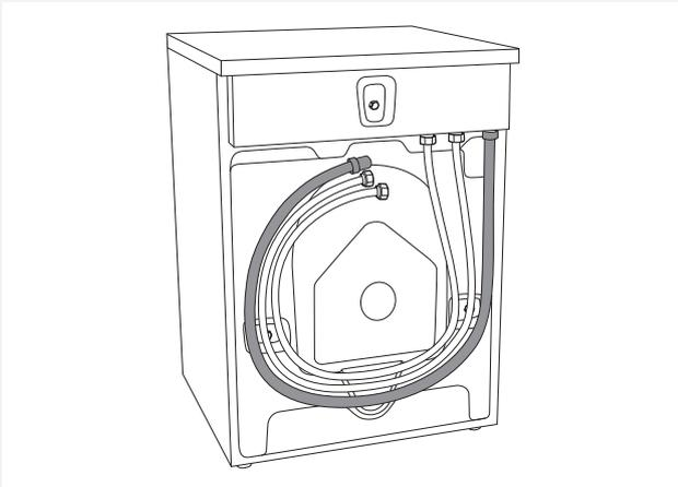
Die Waschmaschine ist mit einem Ablaufschlauch ausgerüstet, der an den Abfluss anzuschließen ist. Sie können den Ablaufschlauch auch in den Wandsiphon montieren, jedoch muss dies fachgerecht gemacht werden, damit er später gereinigt werden kann. Der Ablaufschlauchs muss 600-900 mm über dem Boden montiert werden. Wir empfehlen die untere Position (600 mm). Sorgen Sie dafür, dass der Ablaufschlauch nicht geknickt ist.
