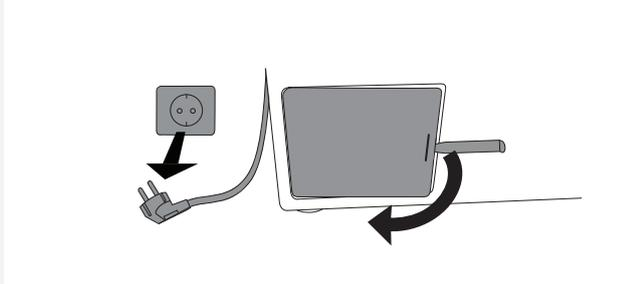
**1** Pumpen Sie vor dem Reinigen der Waschmaschine das Wasser mit dem Programm Abpumpen ab und trennen Sie das Gerät vom Stromnetz.
