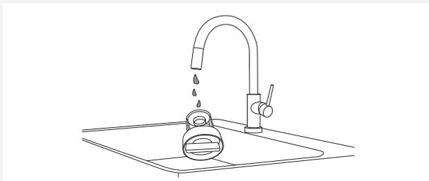
**4** Reinigen Sie den Filter unter fließendem Wasser.
