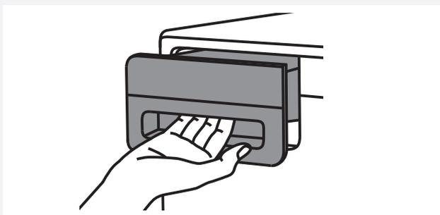
Öffnen Sie den Dosierbehälter bis zum Anschlag! Auf dem Display erscheint die Einstellung des ADS im Hauptmenü.
