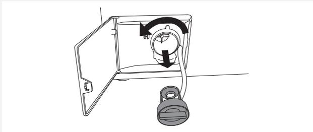
**3** Drehen Sie den Filter langsam gegen den Uhrzeigersinn und ziehen Sie ihn heraus.
