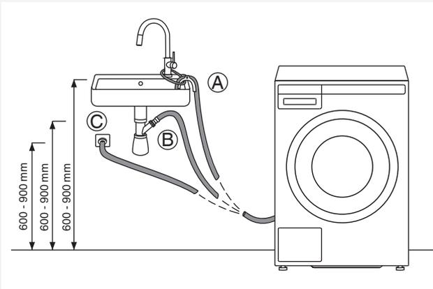
Sie können den Ablaufschlauch auch direkt an den Siphon des Waschbeckens anschließen. In diesem Fall muss der Durchmesser des Schlauchs 600–900 mm über dem Boden montiert sein. Der Innendurchmesser des Schlauchs muss mindestens 18 mm betragen (siehe Abbildung).
