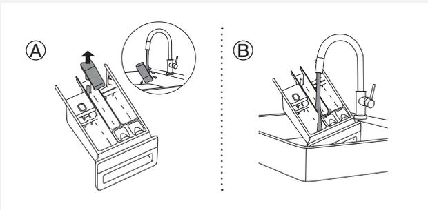
**2** Reinigen Sie den Dosierbehälter und spülen Sie ihn mit Wasser aus. Sie können auch die Abdeckung des Stopfens im Fach (A) für den Weichspüler abnehmen. Reinigen Sie die Abdeckung des Stopfens.
