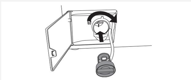
**6** Setzen Sie den Filter wieder in seine Lagerung ein (wie auf der Abbildung dargestellt) und schrauben Sie ihn im Uhrzeigersinn ein. Die Dichtflächen müssen sauber sein, damit die Dichtigkeit gewährleistet ist. Stecken Sie erneut die Abflussrinne ein.
