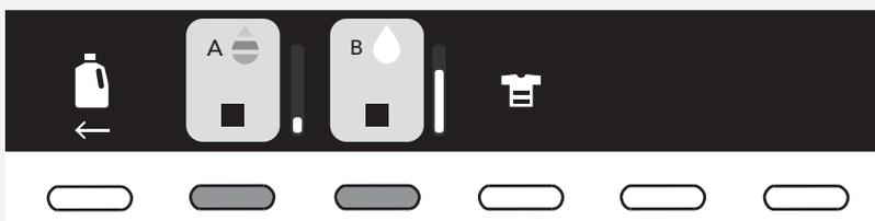
Die Dosierbehälter A und B dürfen nicht abgehakt sein (ohne Häkchen in ). Das System wird das Flüssigwaschmittel nicht automatisch dosieren.
