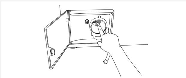
**5** Entfernen Sie alle Gegenstände und Unreinheiten aus dem Filtergehäuse und vom Laufrad.
