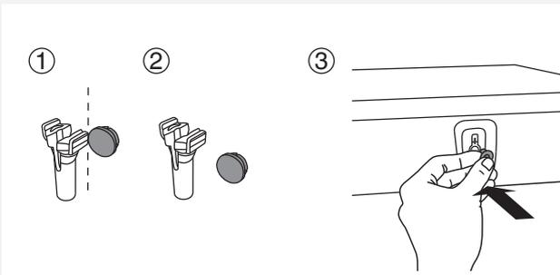
**3** Entfernen Sie die Abdeckungen von den Kunststoffstöpseln. Stecken Sie die Abdeckungen in die drei Löcher, in welche die Kunststoffstöpsel eingesteckt waren. Bewahren Sie die Kunststoffstöpsel auf, für den Fall, dass Sie das Gerät transportieren möchten.
