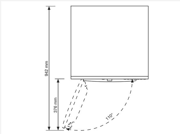
Stellen Sie sicher, dass zwischen dem Gerät und dem Möbelelement oder der Wand Freiraum bleibt, zwischen der hinteren Kante der Oberseite des Geräts und dem Möbelelement oder der Wand sollte mindestens 25 mm Platz frei bleiben.
