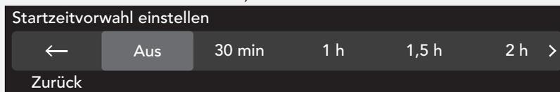
Bewegen Sie sich mit dem Programmwahlknebel durch das Menü „Einschaltverzögerung“ (von 30 Minuten bis 6 Stunden in Schritten zu 30 Minuten und von 6 bis 24 Stunden in Schritten zu 1 Stunde).
