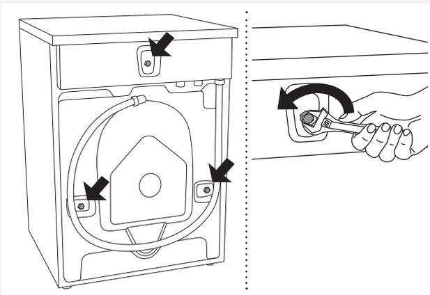
**1** Lösen und entfernen Sie die Schrauben wie auf den Abbildungen dargestellt.
