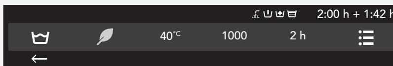
In der oberen Zeile erscheinen die Zeit der Einschaltverzögerung und die Zeit bis zur Beendigung des Waschvorgangs. Nach Beendigung der Abzählung der eingestellten Zeit wird das gewählte Waschprogramm automatisch gestartet.
