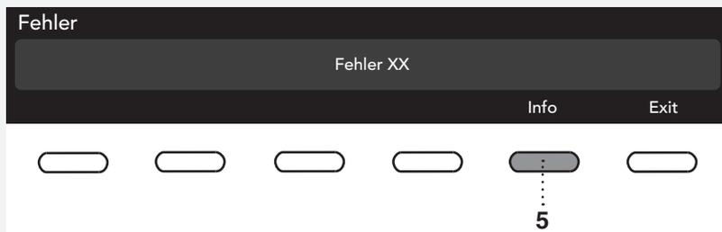
Durch Drücken der Taste INFO wird auf dem Display die Beschreibung des Fehlers angezeigt.
