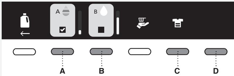
Stellen Sie das automatische Dosieren des Flüssigwaschmittels für jeden Zyklus des Waschvorgangs separat ein. Die letzte Einstellung wird gespeichert. Sie können sie beim nächsten Waschzyklus ändern. Bei einigen Programmen kann die Funktion ADS nicht aktiviert werden.
