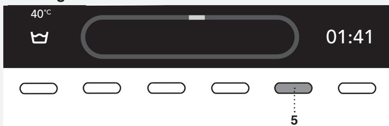
Falls Sie Wäschestücke während der Programmausführung hinzufügen oder entfernen möchten, können Sie mit der Taste **Start /Pause ||** das Programm anhalten. Wählen Sie durch Drücken der Taste 5 die Option „Wäsche hinzufügen“ (Add clothes), falls der Waschvorgang (Kreis) blau hinterleuchtet ist. Falls der Waschvorgang (Kreis) rot hinterleuchtet ist, besteht diese Möglichkeit nicht.
