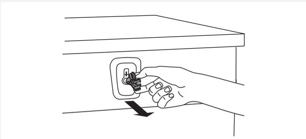
**2** Entfernen Sie die Kunststoffstöpsel, welche die Schrauben halten, indem Sie diese zusammenpressen und dann herausziehen.
