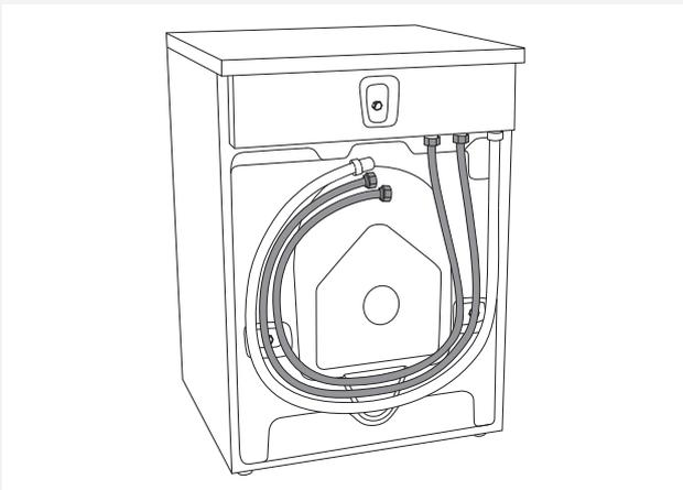
Schrauben Sie den Zulaufschlauch so fest, dass er gut dichtet.
