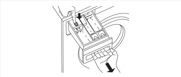
**1** Drücken Sie auf die Lasche und nehmen Sie den Dosierbehälter aus dem Gehäuse des Dosierbehälters heraus.
