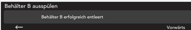
Spülen Sie den Waschmittelbehälter zusätzlich mit 500 ml Wasser aus. Öffnen Sie den Dosierbehälter bis zum Anschlag und füllen Sie ihn mit Wasser; schließen Sie den Dosierbehälter und drücken Sie die Taste **Start ▶**. (Die maximale Wassermenge, die Sie in den Dosierbehälter gießen können, ist 1,5 l.)
