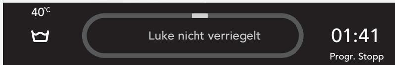
Falls sich die Luke nicht öffnen lässt, kann die Temperatur in der Trommel zu hoch sein, sodass keine zusätzlichen Wäschestücke hinzugefügt werden können.
