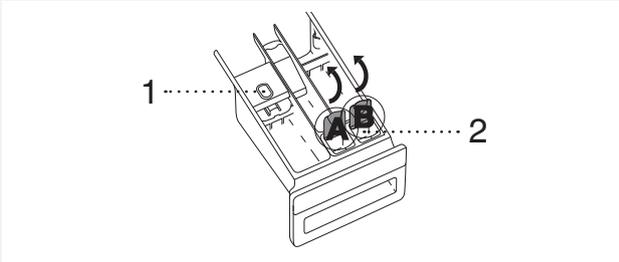
**1** Ziehen Sie den Dosierbehälter durch Drücken der Lasche aus dem Gehäuse heraus (1).
