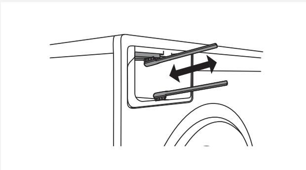
**3** Reinigen Sie mit einer kleinen Bürste auch die Düsen auf der Oberseite des Gehäuses des Dosierbehälters.
