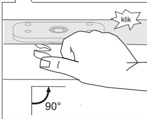
拇指将门锁向右推90°直至听到清脆归位声。门锁已停用。
