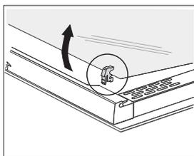
**3** 拆卸第3层玻璃 (依据型号)，缓缓提起，取下。同时，请取下玻璃上的橡胶封。
