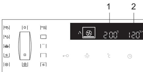
**3** 旋转烹饪系统选择旋钮（循环热风和底部加热器标示）。该符号、烤箱预设温度和烤肉探针预设温度均会在显示屏上出现。按下开始键，开始烹饪。
