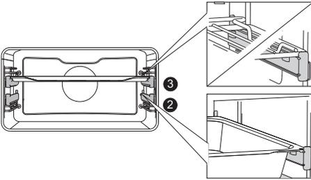
拉出伸缩导轨，将烤架或烤盘放在导轨上，推入烤箱。
