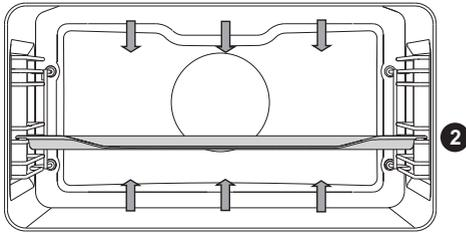
顶部外圈加热器和底部加热器同时工作均匀分布烤箱中的热空气。
