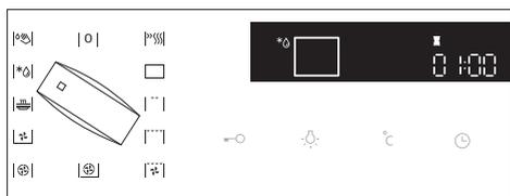
旋转烹饪系统选择旋钮至解冻功能。时间将会显示在屏幕上，可以调节时间。按开始键开始。
