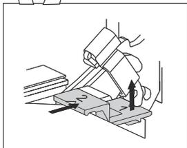
**1** 提起左右两侧的卡扣 (标志1处)，向前推卡扣 (标志2处)，此时，左右两侧的卡扣均被取下。
