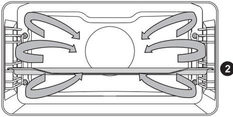
周围的加热器和风扇会同时运行。背部的风扇可将热空气不断均匀分布在烤箱内部烤制食物。
