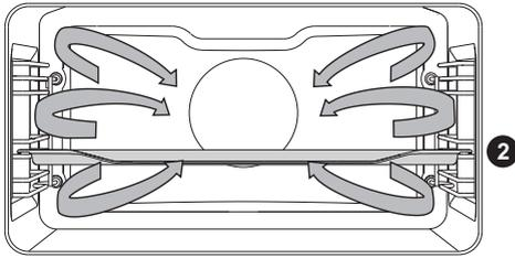
周围的加热器和风扇一起启动，背部的风扇可将热空气不断均匀分布在烤箱内部烤制食物。
