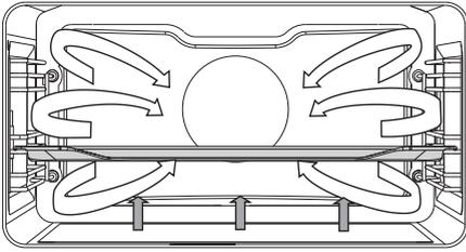
此模式下烘焙酵母类糕点，保存蔬果。使用第二层（自下而上），使用浅烤盘能够让热空气在食物上方循环。
