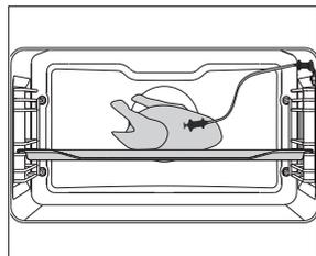
**2** 连接烤肉探针到插槽，针头插入食物中。（任何定时被启动则探针模式会取消。）
