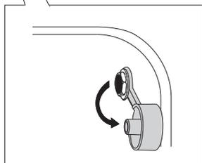
**1** 移开金属盖帽（烤箱右壁上方的插槽）。
