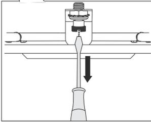
**1** 将顶部加热器向外拉，将烤箱内顶部前端的螺丝卸下。
