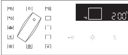
旋转烹饪系统选择旋钮至快速预热模式。预设温度会显示在屏幕上，此温度可以调节。
