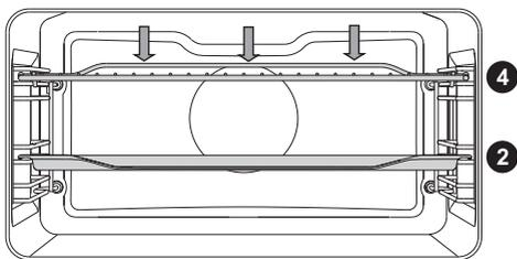
当选择全区域烧烤功能时，顶部内外加热器同时工作。当食物较少时，可以选择只开启顶部内圈加热器。
