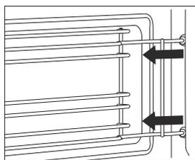
2 将导轨从后壁的洞中取下。
