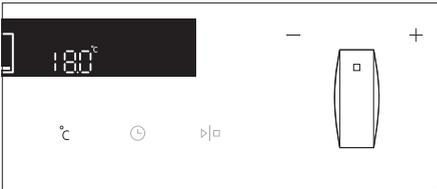
**2** 点击温度键。旋转设置旋钮 (-/+ )选择预想的温度。
