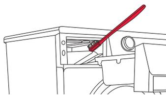
**2** Separat, curățați cu o perie duzele din partea superioară a camerei de clătire.
