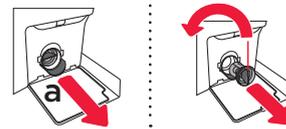
**2** Îndepărtați pâlnia de evacuare a apei (a) înainte de a curăța filtrul. Rotiți ușor filtrul în direcția acelor de ceasornic (b). Scoateți filtrul pentru a permite apei să se scurgă încet.
