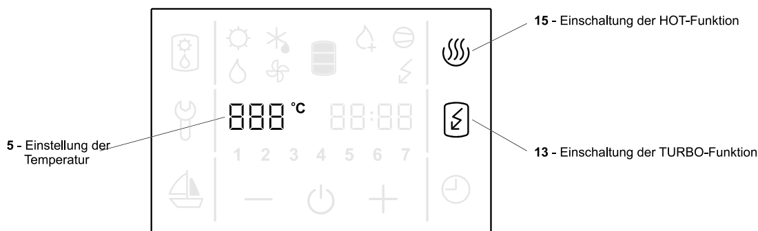
Рис. 18. Налаштування температури, увімкнення режимів «ТУРБО» та «ГАРЯЧА ВОДА»
