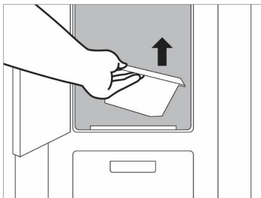
Figure 15: Enlèvement de la flamme de guidage
