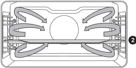
Neste modo, a resistência circular e o ventilador funcionam ao mesmo tempo. O ventilador situado na parede traseira da cavidade do forno garante que o ar quente circule constantemente ao redor do assado ou prato de confeitaria/pastelaria.
