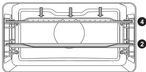
Quando se usa o grelhador, a resistência 4 superior e a resistência do grelhador instalado no teto do forno funcionam ao mesmo tempo.
