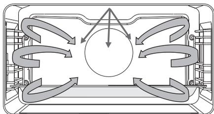
Neste modo, o alimento é cozido com uma combinação de micro-ondas e grelhador.
