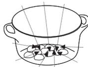
Quando um alimento é exposto a micro-ondas, as moléculas começam a se movimentar rapidamente, gerando calor.
