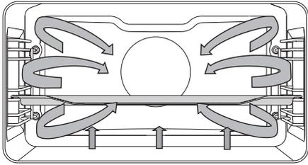
Neste modo, a resistência inferior, a resistência circular e o ventilador de ar quente funcionam ao mesmo tempo. Indicado para assar pizzas, tortas de maçã e bolos de frutas.
