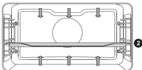
Neste modo, as resistências na parte inferior e no teto da cavidade do forno irradiam calor de maneira uniforme para o interior do forno.
