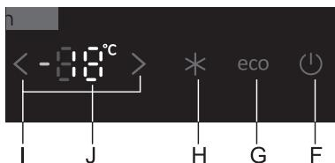
Pour activer la fonction **Eco**, appuyez sur la touche **G**. Lorsque cette option est active, l'appareil fonctionne avec les réglages les mieux adaptés.
