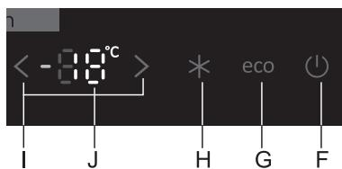
**Pour arrêter l'appareil entier, appuyez 3 secondes sur la touche F** (attention : le combiné demeure sous tension, c'est-à-dire que le courant électrique est toujours présent).
