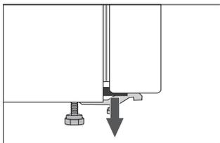
Ukse nurkadesse on paigaldatud vahepuksid. Eemaldage need ja pange komplektisolevad pistikud nende pesadesse (ainult osadel mudelitel).
