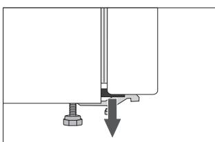
Rohy dveří jsou opatřeny distančními vložkami. Odstraňte je a zasuňte do jejich drážek čepy, které jsou součástí dodávky (pouze u některých modelů).
