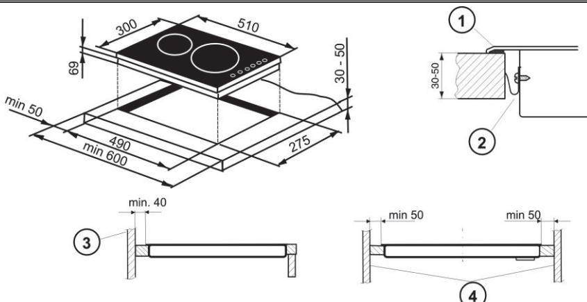
Если толщина рабочей поверхности превышает 30мм, то необходимо подправить ее форму в месте вывода охлаждающего воздуха из прибора (см. рисунок)
