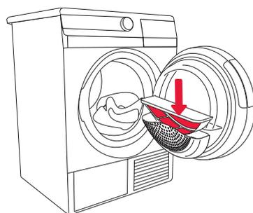
**3** Вставте сітчастий фільтр і закрийте кришку фільтра.
