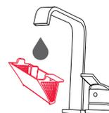
**3** За потреби ретельно промийте фільтр під проточною водою.
