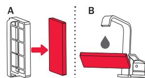
**3** Від'єднайте фільтр від ручки та почистіть корпус за допомогою вологої тканини.
