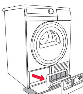
**2** Тримаючись за ручку, витягніть поролоновий фільтр теплового насоса із сушильної машини.
