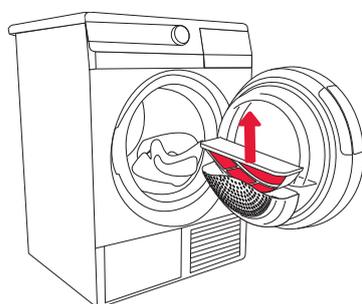
**1** Відкрийте кришку фільтра та **вийміть** сітчастий фільтр.
